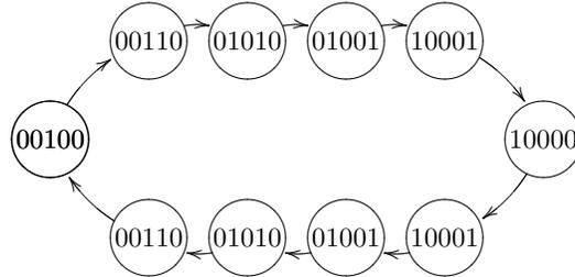
L'affectation des mots à un nombre pair peut être vue comme utilisant des automates séquentiels élémentaires qu'on appellera  $Machine_3$ ,  $Machine_5$ , ...,  $Machine_{2k+1}$ .
